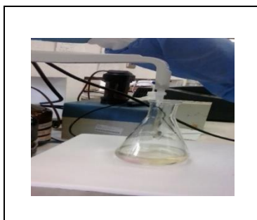
Figura 8. Montaje experimental: Determinación del índice de acidez del aceite de vísceras de pescado
