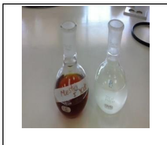
Figura 9. Montaje experimental, determinación del índice de Yodo del aceite de vísceras de pescado
