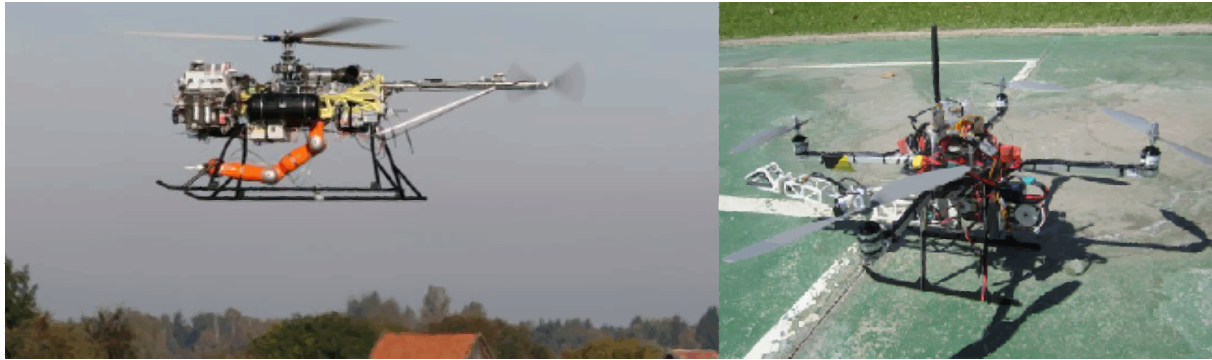
Figura 5. Helicóptero autónomo con brazo robótico (izq.). UAV con brazo robótico (der.) Fuente: ajustado de Kondak et al. (2018) y Jiménez-Cano et al. (2013) .
