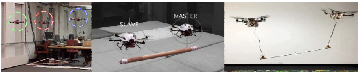
Figura 11. Transporte de carga suspendida por medio de UAV
