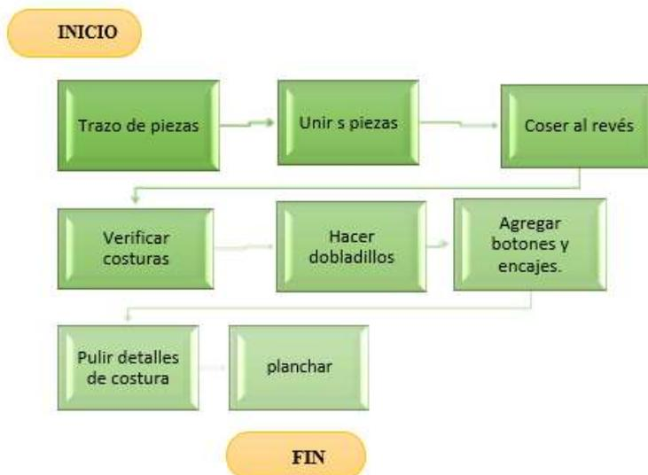
El diagrama de bloques del proceso de producción de un vestido ajustado se realiza con el fin de conocer específicamente la materia prima, la cantidad de procesos y la forma en la que se presenta el producto terminado, para el caso de la elaboración o producción del vestido se pierden retazos de tela en el momento del primer proceso el cual fue el trazo de las telas. A continuación, relaciono los procesos realizados para la elaboración de la prenda de vestir para el caso un vestido ajustado:
