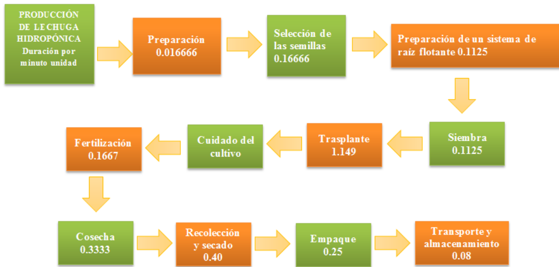
Ilustración 6 Diagrama de bloque proceso de producción por tiempo
