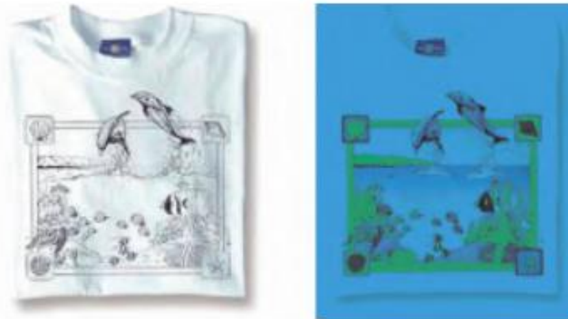
Figura 2. Camiseta de algodón con colorantes sensibles a la luz solar. A la sombra (izquierda) y expuesta al sol (derecha).(R. Sánchez Javier, 2007).
