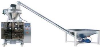
Rango de pesaje 10g – 5000g Rango peso programable de las bolsas 500g - 4000g Velocidad empaquetado 10 – 55 Bolsas por minuto Volumen de la tolva 45L Entrada de energía 380 V Potencia 3.5 KW
