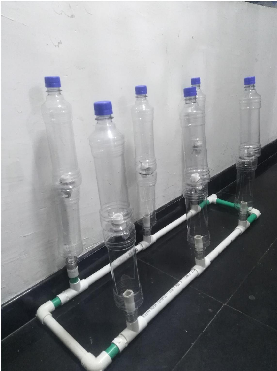
Imagen . Corresponde a 2 modulo para ensamblar. Corresponde al prototipo del sistema de recolección de aguas lluvias.
