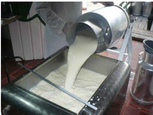
**Estandarización:** En este proceso, con la utilización de la descremadora, se normaliza la grasa en un 2% y de sólidos en un 7%, para una distribución homogénea de la grasa debe precalentarse a 35°C.
