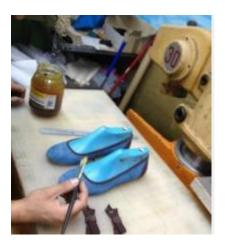
En este proceso, se procede a montar los adornos o las partes exteriores que van pegadas.
