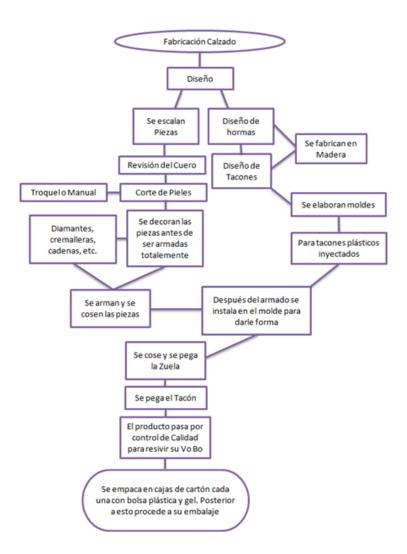
Diseño corte de moldes La primera operación es la elección de los materiales a utilizar. Se seleccionan las pieles, las telas, los forros y todos los elementos del calzado. Con ayuda de moldes especiales se van dibujando una a una las siluetas.
