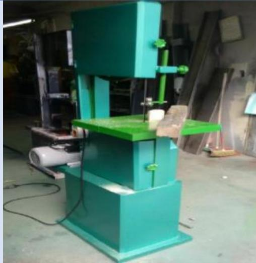
Sierra que se usa para cortar una gran gama de productos, desde madera hasta metales. Una sierra sin fin es una máquina de corte que es funcional en muchos rubros, pues permite realizar distintos tipos de corte.
