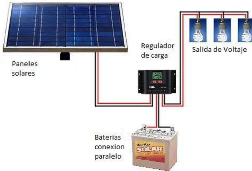
**Figura 6** Circuito Sistema energía solar
