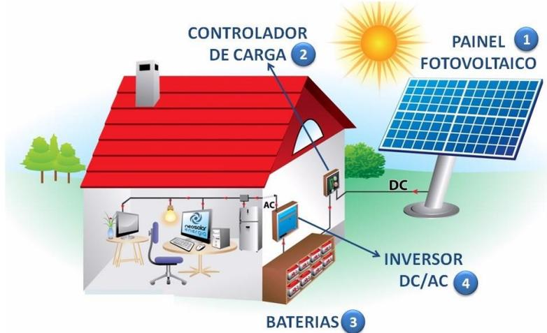
Los sistemas domóticos con la energía fotovoltaica funcionan de tal manera que el panel recibe la energía solar transmitiéndola hacia una serie de procesos de regulación de voltaje para ser almacenada en un banco de baterías y distribuida a la red eléctrica en operación que en este caso sería el sistema domóticos haciendo que su operación sea normal y constante y sin dependencia de una red eléctrica externa o adicional.
